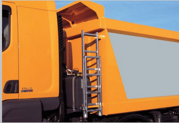
Schutzdach und klappbare Aufstiegsleiter
