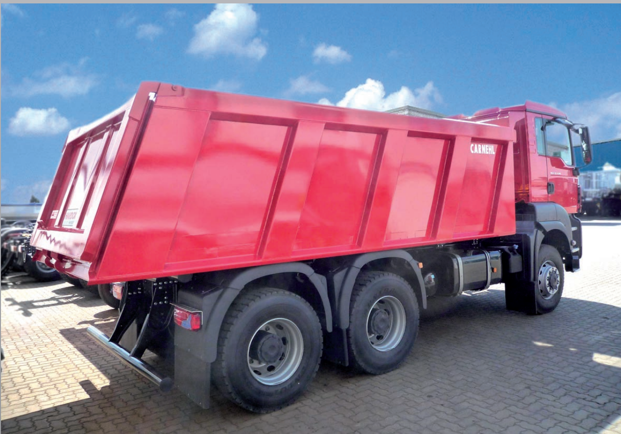
Hardox-Kastenmulde in Spantenbauweise
