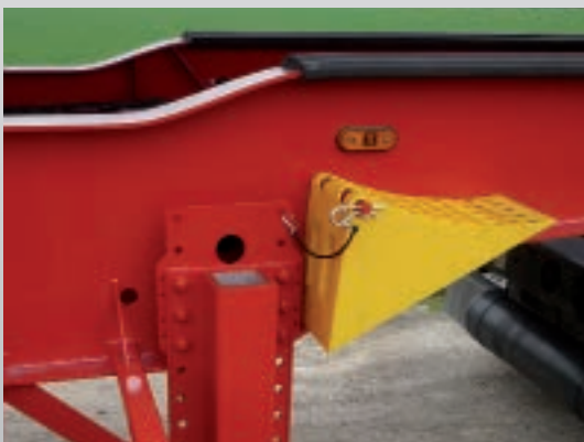
Gekröpftes Chassis zur Reduzierung der Gesamthöhe
