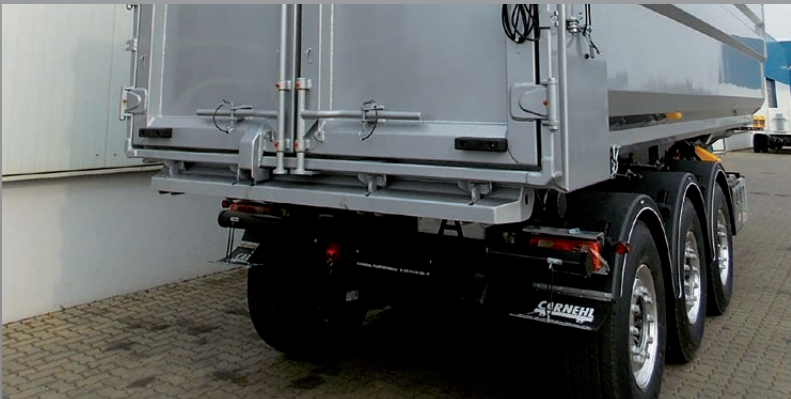
Hardox-Großraum: Flügeltüren mit Visier (4-fach Verriegelung)
