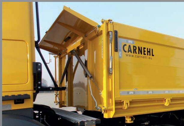
Bedienstand für Rollplane mit klappbarem Schutzdach
