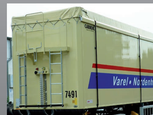
Podest mit beidseitigem Aufstieg
