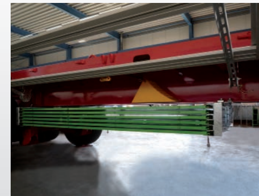
Geschraubtes Bordwandablagegestell, verzinkt
