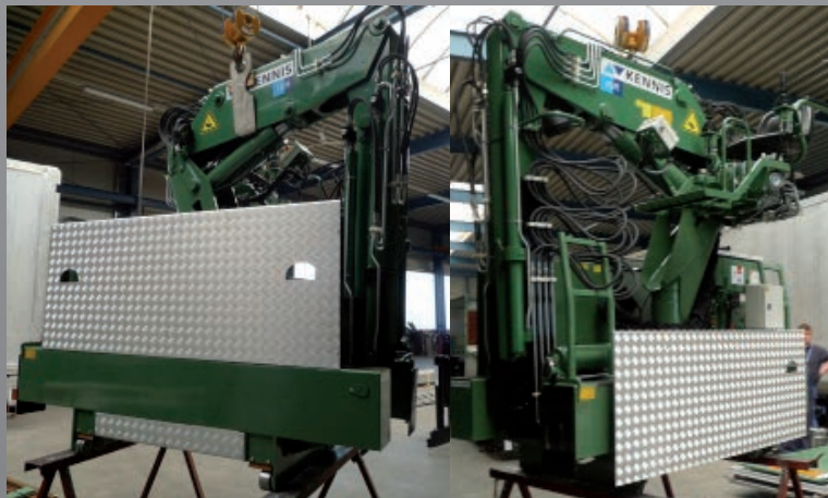
Rollkran, als rückwärtige Sicherung zertifiziert
