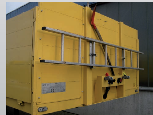
Leichte Stirnwand aus Aluminium
