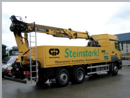
Pritschenaufbau mit Heckkran
