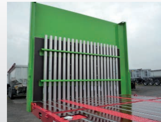
Rungenablage hinter Stirnwand
