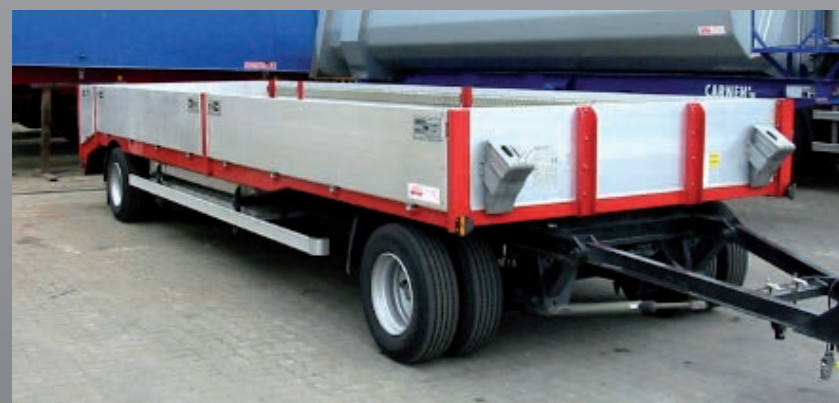
Pritschenanhänger mit Rampen, überfahrbar
