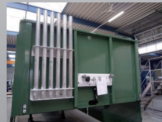
Zertifizierte Stirnwand aus Stahl-mit Rungenablage
