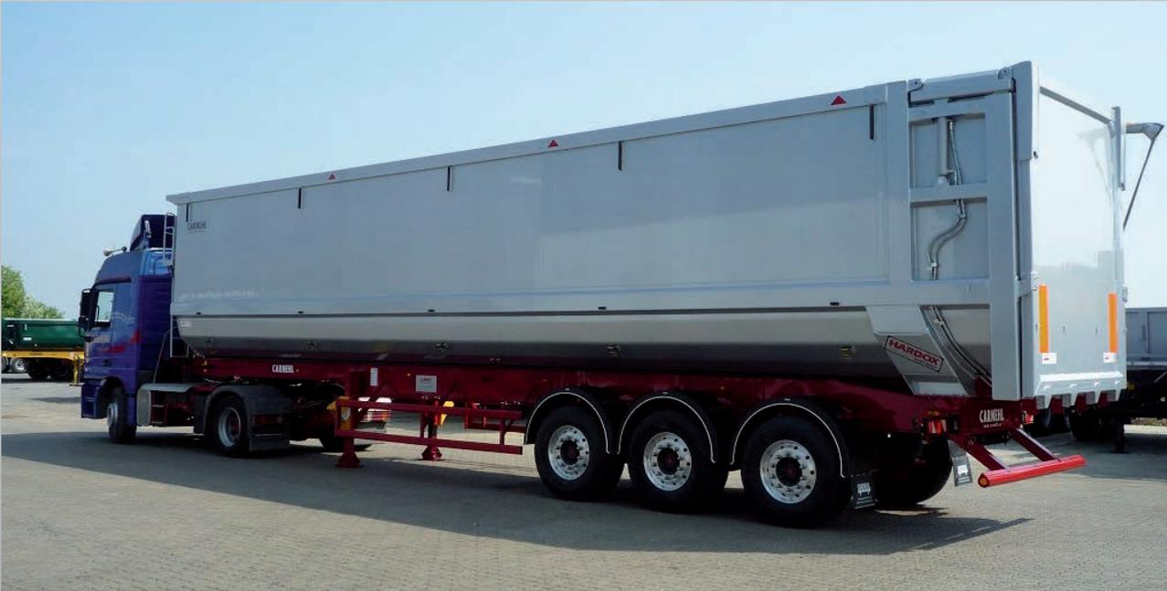
Kombimulde mit gestecktem Oberteil aus Aluminium
