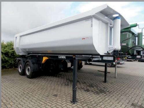
2-Achser mit Schwenkstützen f. Vollabsattlung
