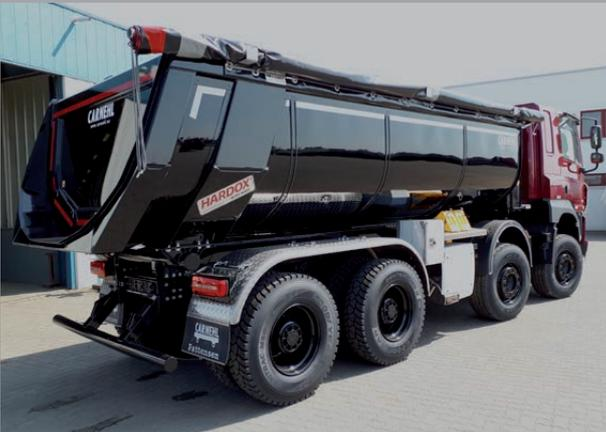
Motorwagen Thermomulde mit GFK-Abdeckung
