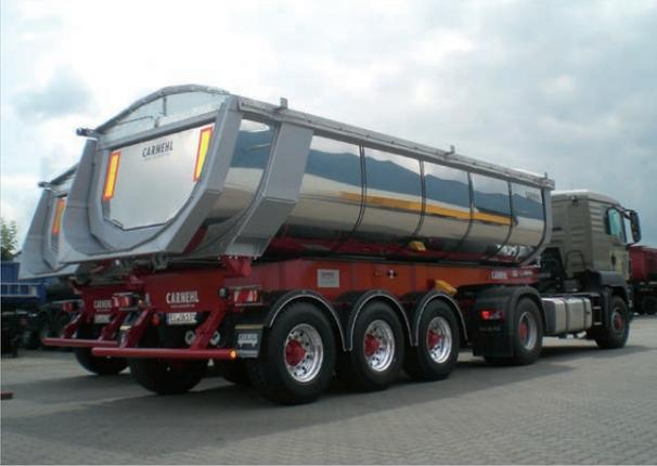
mit Edelstahl-Abdeckung bei innenliegender Rückwand
