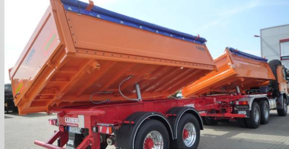
Seiten-Kippaufbauten für Motorwagen mit passendem Anhänger
