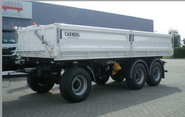
3-achsig, mit Stahlbordwänden
