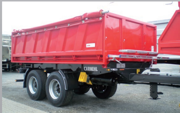
...mit Stahlbordwänden in Jetbauweise
