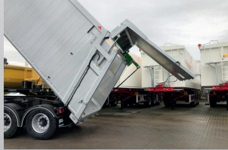
... und hydraulischer Rückwand (2310iL)
