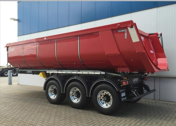
mit GFK-Abdeckung bei innenliegender Rückwand
