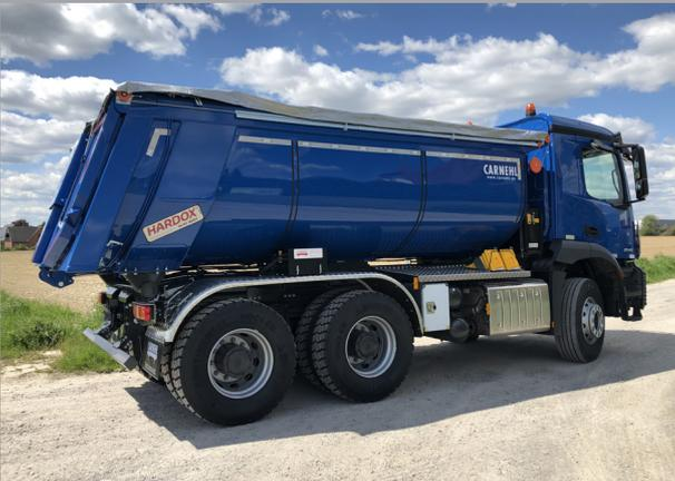
Motorwagen Thermomulde mit GFK-Abdeckung
