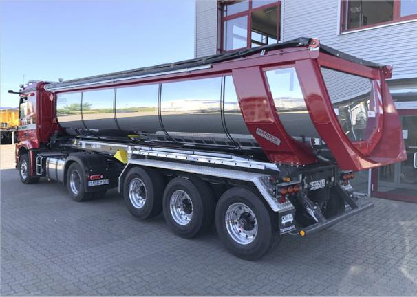
mit Edelstahl-Abdeckung bei innenliegender Rückwand
